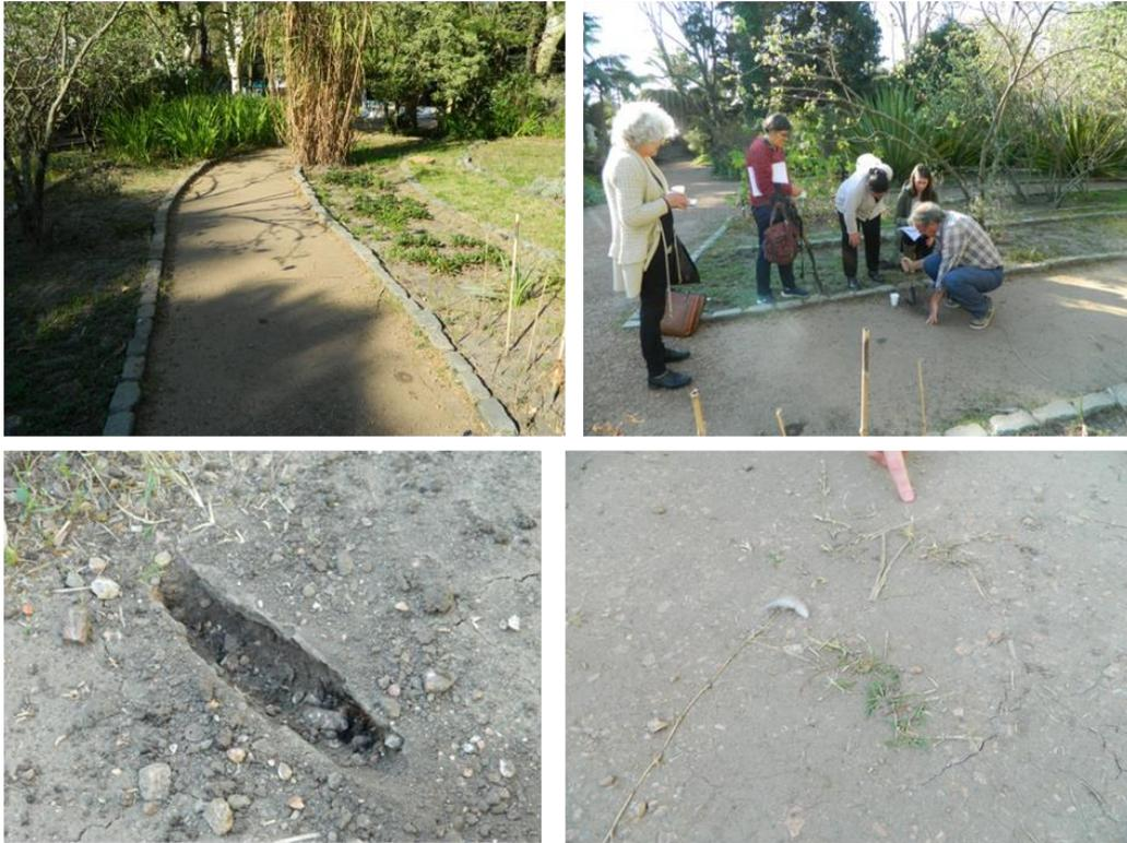
Figura 2. En el sentido de las agujas del reloj: vista general del camino en la Quinta de Behrens, los estudiantes tomando muestras y anotaciones del camino, la escasa cobertura vegetal del camino, y el pozo muy somero hecho a pala debido a la dureza y compactación del suelo.
